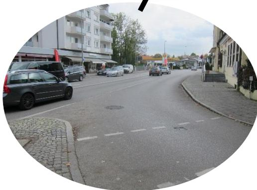
Radfahrern auf der Augsburgener Straße befinden sich nach Überquerung der Kreuzung zwischen Mittelspur und Rechtsabbiegespur aus der Puchheimer Straße. Dabei werden sie durch einfädelnden Autos von der rechten Spur konfrontiert. Den Radfahrern fehlt die Sicherheit eines Fahrradstreifens, der sie vorfahrtsberechtigt an den rechten Fahrbahnrand der Augsburgener Straße führt. Die Radverkehrsführung entspricht nicht den Vorgaben der ERA2010.
